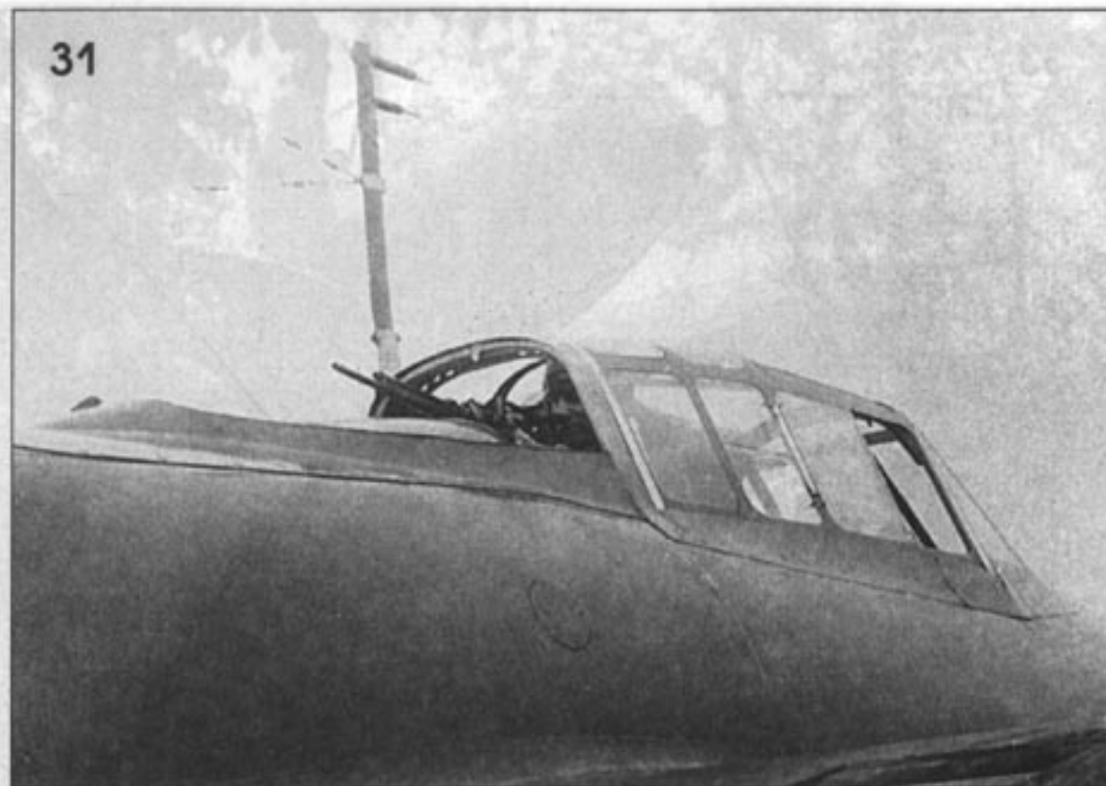
31,32. Установки пулемета ШКАС — верхняя ТСС-1 и нижняя люковая МВ-2 на первых серийных Пе-2. ShKAS machine gun mounts: the dorsal TSS-1 and auxiliary MB-2 on the early serial Pe-2 aircraft.
