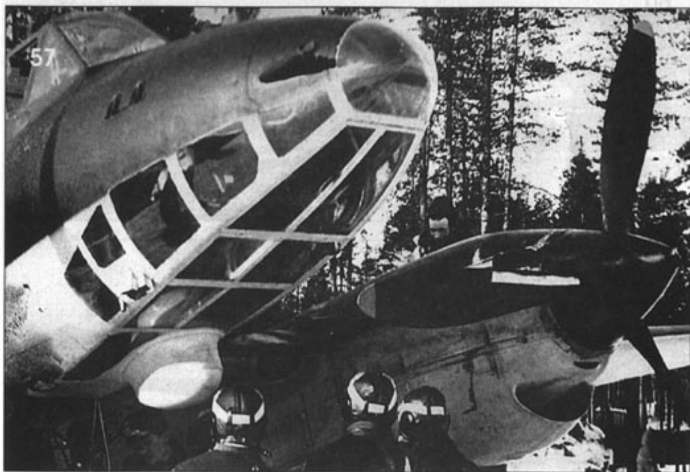
57. Остекление носовой части фюзеляжа на ранних сериях самолета Пе-2. The nose glazing of the early series Pe-2.
