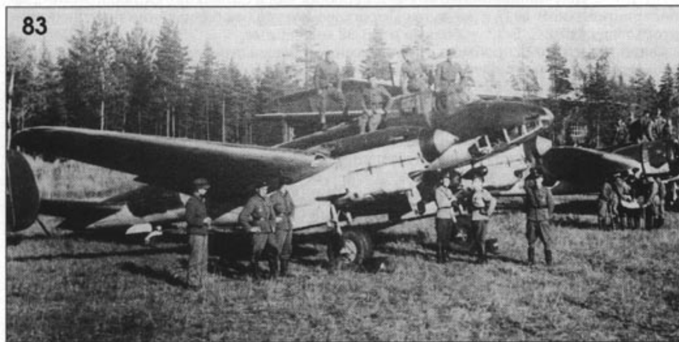
81-84. Трофейные самолеты Пе-2 в Финляндии. Перед лобовым стеклом фонаря видна установка прицела Revi. Самолеты относятся к ранним сериям (еще отсутствует установка ФТ), скорее всего, они были захвачены немцами в 1941 году. Captured Pe-2 aircraft in Finland. A German Revi gunsight is visible just behind the windscreen. These are aircraft from the early production series (still equipped with the FT installation) which leads to the conclusion they were captured early on by the Germans in 1941.
