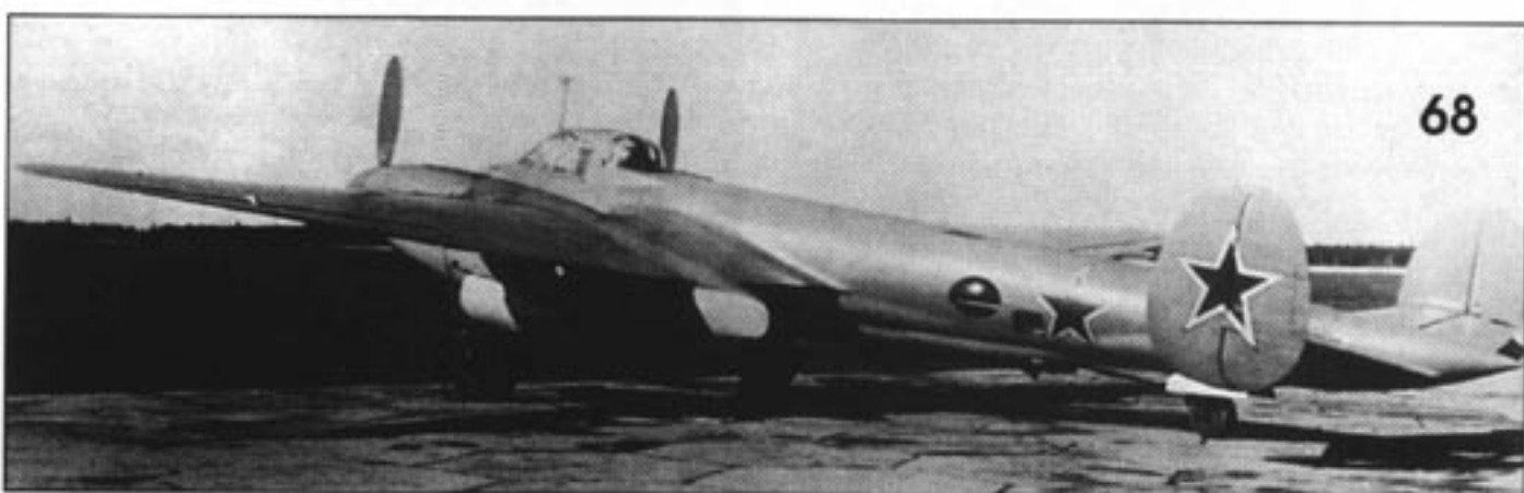
67, 68. Самолет Пе-2М. Хорошо видны верхняя и нижняя установки пушек УБ-20. The Pe-2M. These photos give a good view of the upper and lower UB-20 cannon installations.
