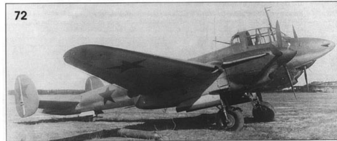
72. Опытный Пе-2 187-й серии с турелью «ФТ». A prototype Pe-2 from Series 187 with the FT turret.
