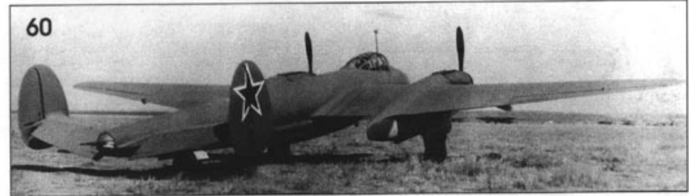
60, 61. Пе-2И мог служить эталоном красоты и чистоты аэродинамических форм. Перед бомбоотсеком видна головка оптического прицела-перископа ОПСК. The Pe-2I showed the evolving beauty and clean form of the design. Just in front of the bomb racks is the sight head for the OPSK periscopic optical bombsight.
