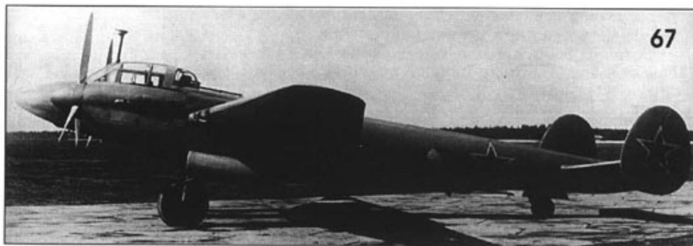
67, 68. Самолет Пе-2М. Хорошо видны верхняя и нижняя установки пушек УБ-20. The Pe-2M. These photos give a good view of the upper and lower UB-20 cannon installations.
