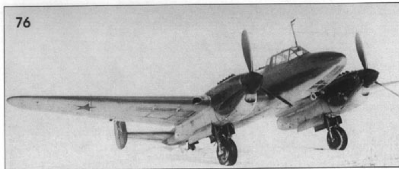
76, 77. Пе-2 с двигателями М-1. Обратите внимание на расположение выхлопных патрубков на верхней части мотогондол.
